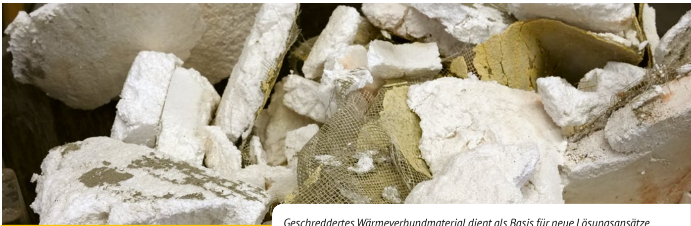
Geschreddertes Wärmeverbundmaterial dient als Basis für neue Lösungsansätze.
