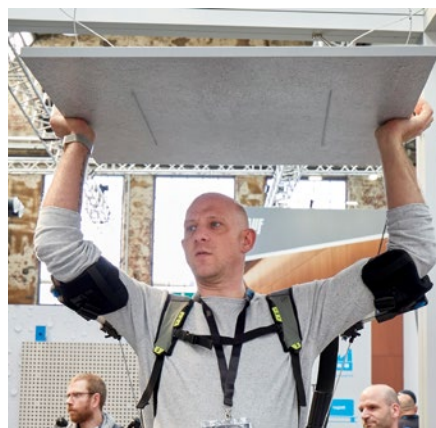
Arbeits erleichterung auf der Baustelle. Welche Vorteile ein Exoskelett beim Arbeiten über Kopf bringt, konnte selbst erlebt und ausprobiert werden.
